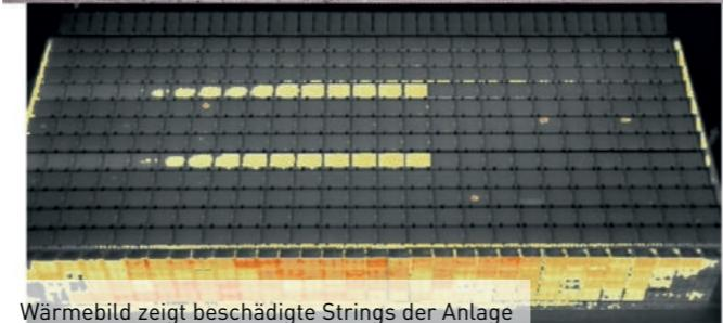
Wärmebild zeigt beschädigte Strings der Anlage
